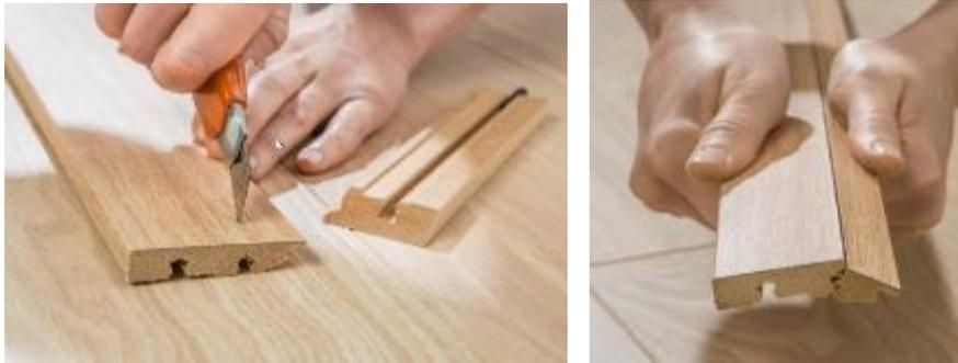
请注意，如果将踢脚板切割为 40 毫米高的板，则不能使用 Hydrostrip (NEHSTRIPSK)。
